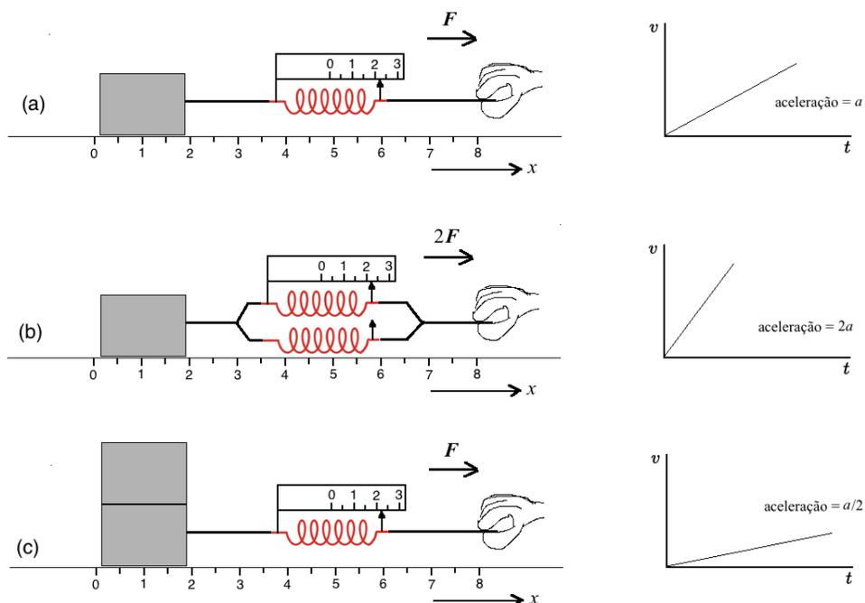
Figura 2: Esquema de experimentos dinâmicos simples que podem servir de base para a determinação da segunda lei de Newton.
