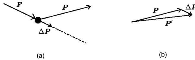
Figura 3: Mudança  $\Delta\mathbf{P}$  no momento linear  $\mathbf{P}$  de um corpo devida a uma força  $\mathbf{F}$  feita durante uma colisão com outro corpo. Após a colisão, o momento linear é  $\mathbf{P}'$ .
