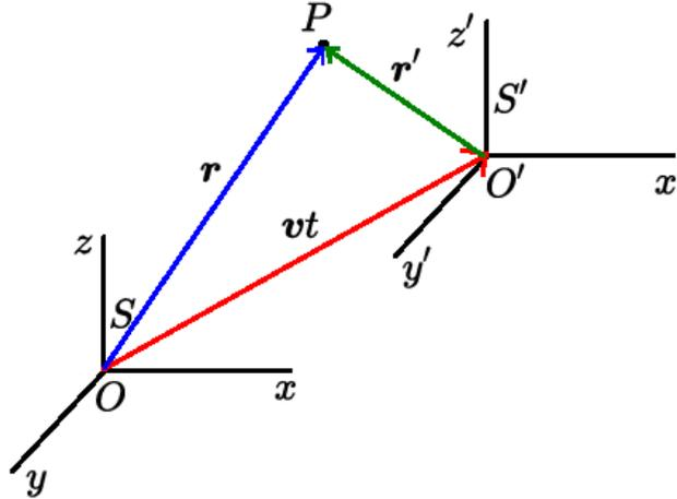
Figura 8: Vetores de posição  $\mathbf{r}$  e  $\mathbf{r}'$  de uma partícula  $P$  em relação a dois referenciais,  $S$  e  $S'$ .  $S'$  move-se em relação a  $S$  com velocidade  $\mathbf{v}$ .
