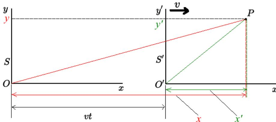
Figura 7: Movimento de uma partícula  $P$  em relação a dois sistemas de coordenadas,  $S$  e  $S'$ .  $S'$  move-se em relação a  $S$  com velocidade  $v$ .
