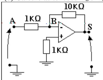
Esta é um circuito inversor multiplicador de tensão, onde  $V_S = (-10k\Omega / 1k\Omega) * V_A = -20V$ . Contudo, o ganho é limitado pela alimentação, não podendo passar dos 15 (10, na versão B) V em módulo. Logo, a tensão  $V_S = -15(10)V$ .
