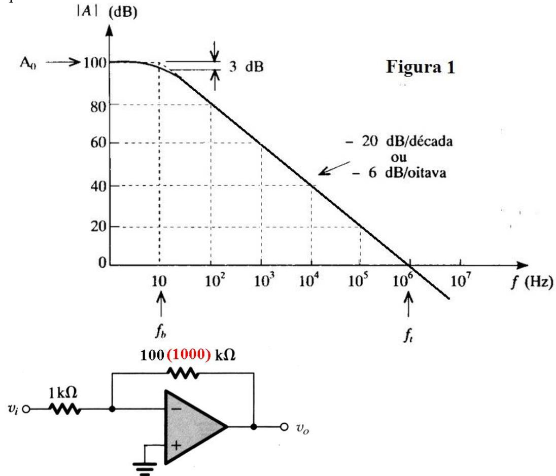
a) Esboce o diagrama de Bode da configuração inversora sobre a curva fornecida da resposta em frequência do Amp Op em malha aberta.
