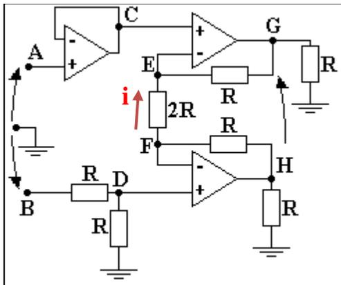
Considerando amp ops reais e presença de curto virtual entre as entradas (C e E, F e D e A e C), a tensão em E é praticamente igual à tensão A, ou seja,  $V_E = V_A = 3V$ . Já a tensão em F é igual à tensão D, a qual por sua vez é metade da tensão em B, de acordo com a ilustração acima. Logo,  $V_F = V_D = 4,5V$ , e a diferença de tensão entre F e E é  $V_{FE} = (4,5 - 3)V = 1,5V = 2R * i$ , onde i é a corrente que passa na resistência 2R.
