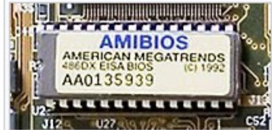
Chip de BIOS do tipo DIP (Dual In Parallel), encontrado em placas-mãe antigas
