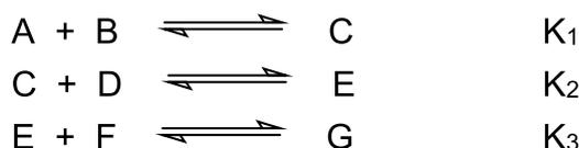
Demonstrar que para a reação global:  $\text{A} + \text{B} + \text{D} + \text{F} \rightleftharpoons \text{G}$ , a constante de equilíbrio será dada por:  $K = K_1 K_2 K_3$ .
