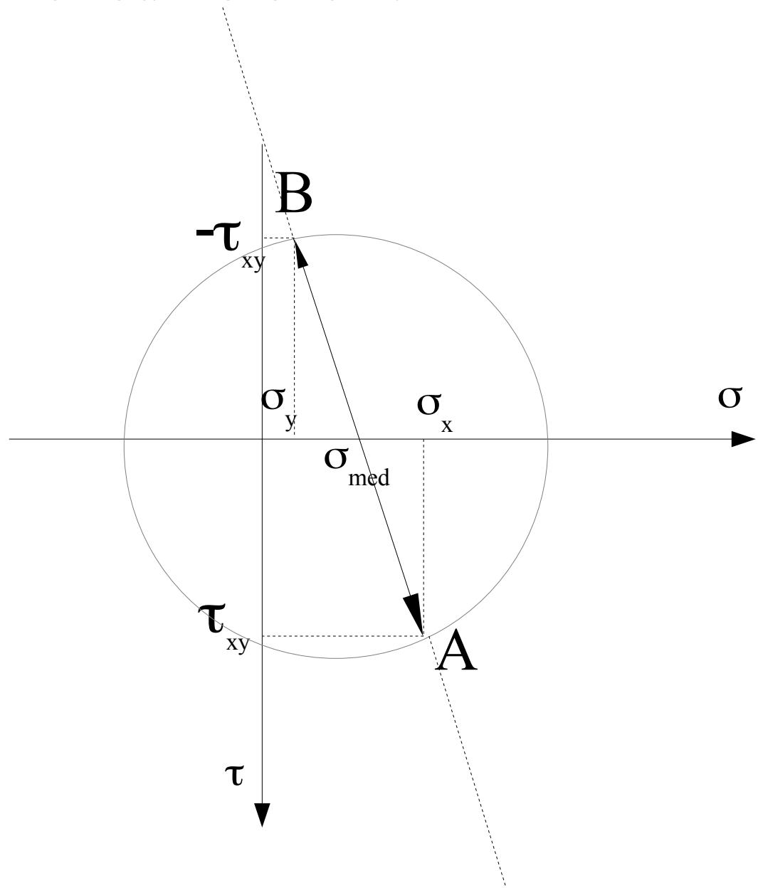
4. Identifique as tensões principais ( $\sigma_1^p$  e  $\sigma_2^p$ ), e a máxima tensão de cisalhamento ( $\tau_{\max}$ ).
