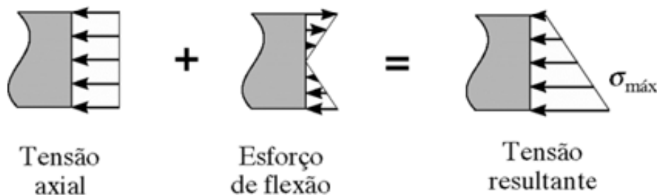
Figura 22.19 Aplicação da sobreposição dos efeitos para a determinação da tensão normal máxima.
