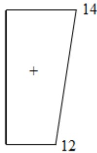
Figura 14.50 Diagrama de esforço normal barra BC.
