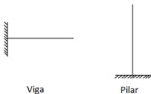
Figura 4.5 Vigas e colunas.
