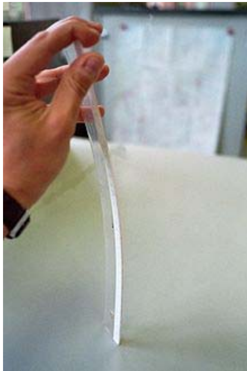
Figura 1.1 Perda de estabilidade em uma régua comprimida.
