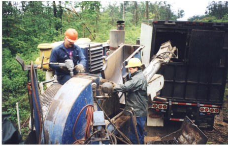
Figura 17. Processo de troca de facas (Esq.) e disco com facas (Dir.).
