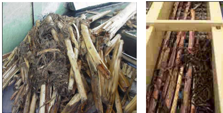
Figura 9. Perdas de madeira (Esq.) e fitas de cascas (Dir.) acompanhando toras ao picador (FOELKEL, s.d.)
