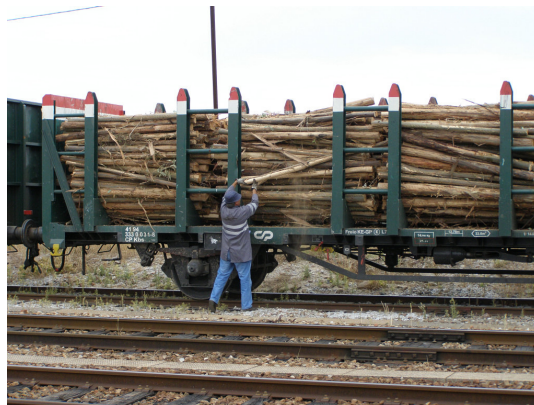
Figura 26. Vagão especial para transporte de toras (Foto: José Souza).
