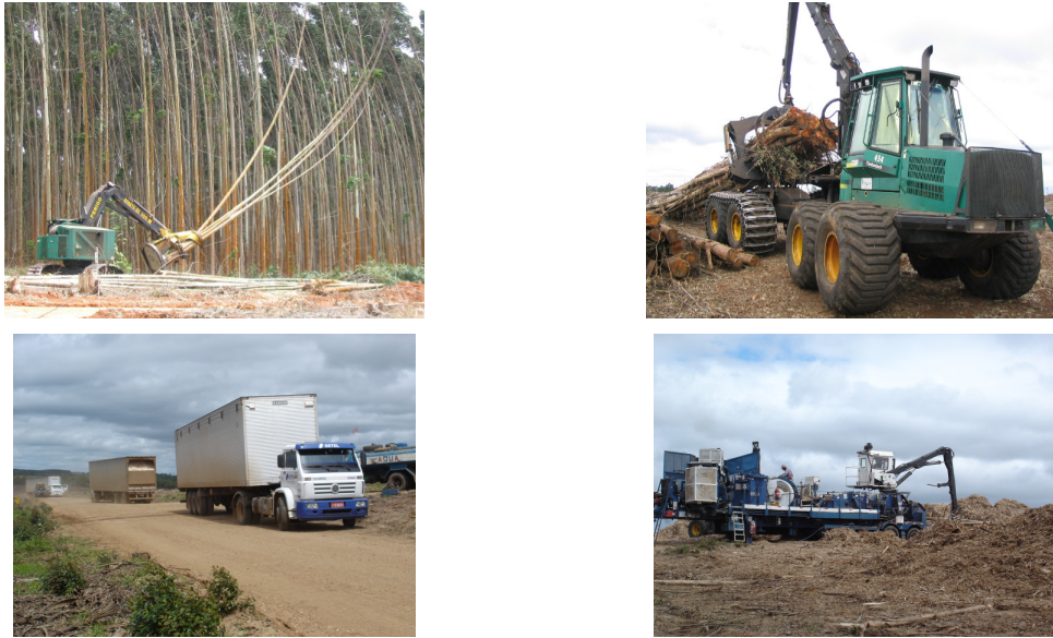
Figura 11. Módulo mecanizado de produção de cavacos no campo: feller buncher Timberjack 608S, “clam bunk” skidder Timberjack 1710 D, “delimber/debarker/chipper” DDC 5000 G, carreta para transporte de cavacos (sentido horário).
