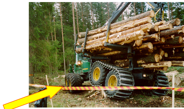
Figura 30. Expansão da largura da caixa de carga do forwarder Timberjack 1410D, com conseqüente aumento da estabilidade da máquina.
