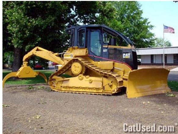
Figura 9. Skidder Caterpillar 527 equipado com esteiras rígidas
