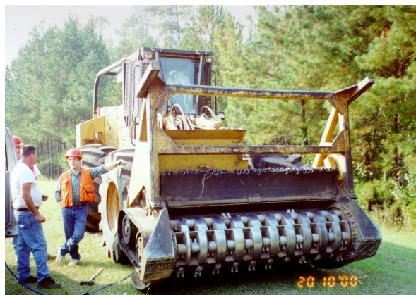
Figura 14. Implemento modelo Magnum 500 utilizado para trituração de galhadas e rebaixamento de tocos.
