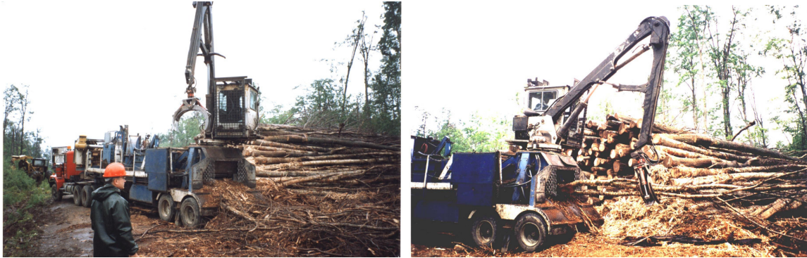
Figura 15. Árvores empilhadas (Esq.) e alimentação do DDC 5000 (Dir.).
