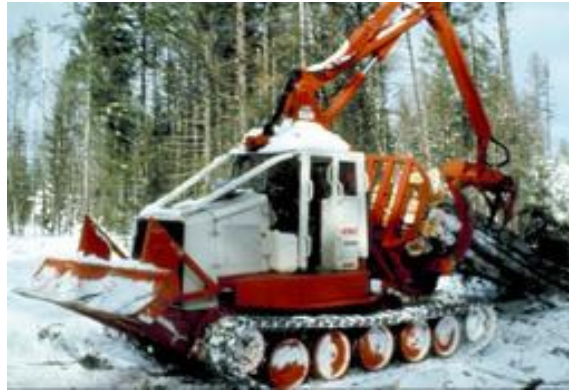
Figura 10. Skidder FMC equipado com esteiras flexíveis (Foto: J.M. Gruber)
