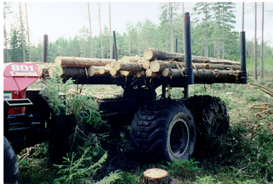
Figura 13. Vista da caixa de carga móvel do “harwarder” Valmet 801 Combi/330 Duo.
