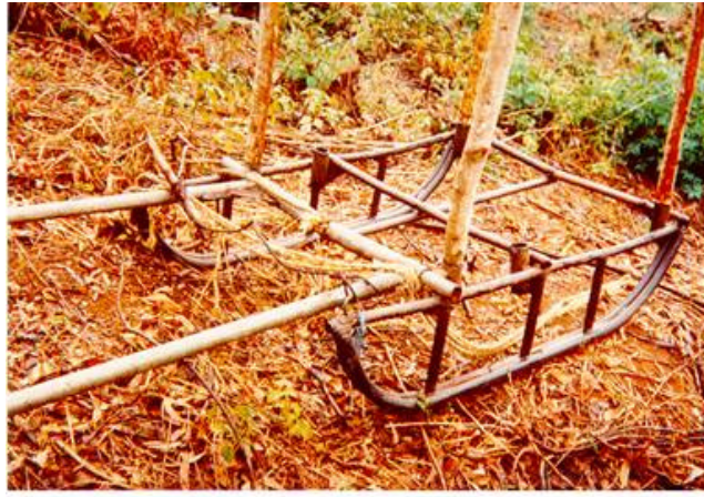
Figura 7. Treno para transporte de toretes com capacidade de 1,5 st.
