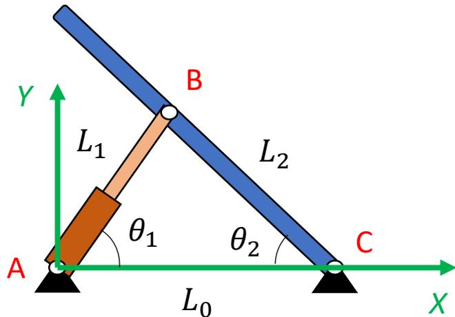
A **Equação Vetorial Fechada** do mecanismo é dada por:  $\vec{r}_{AC} + \vec{r}_{CB} - \vec{r}_{AB} = \vec{0}$
