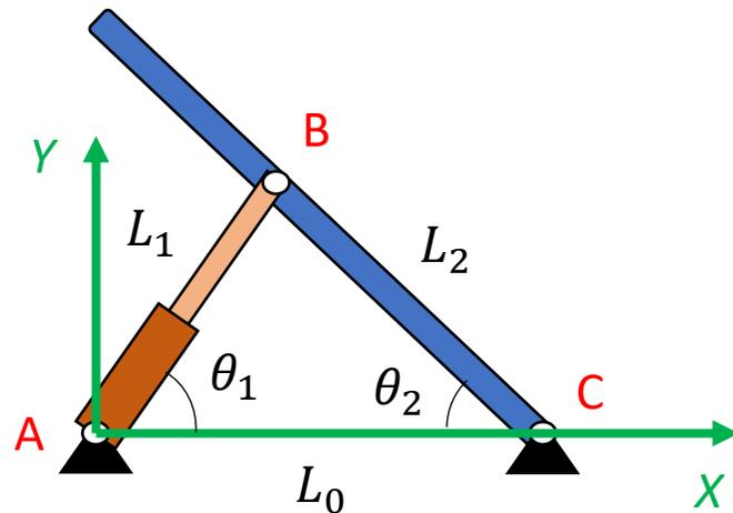
Considerando-se uma aceleração  $\ddot{\theta}_2$  e variando-se o ângulo de entrada  $\theta_2$ , pode-se determinar as acelerações  $\ddot{\theta}_1$  e  $\ddot{L}_1$ :
