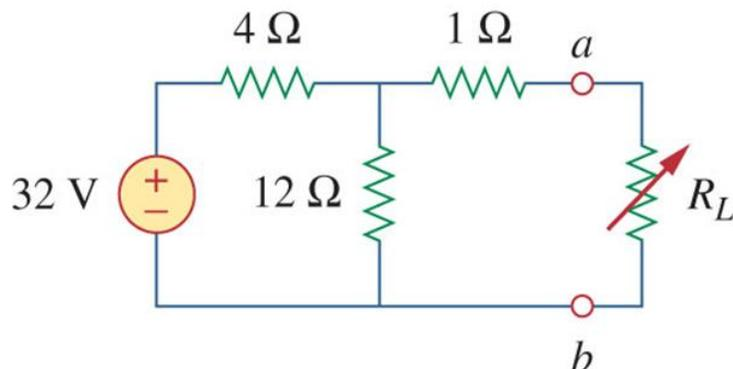
Como a tensão nos terminais  $a$ - $b$  varia em função de  $R_L$ ?
