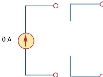
Portanto, para se excluir a influência de uma fonte de corrente no circuito no qual ela se conecta, deve-se substituí-la por um ramo aberto.
