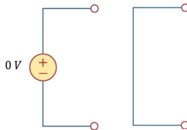
Portanto, para se excluir a influência de uma fonte de tensão no circuito no qual ela se conecta, deve-se substituí-la por um ramo curto-circuitado.
