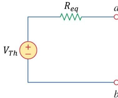
Assim, o objetivo é de calcular os parâmetros  $V_{Th}$  e  $R_{eq}$  nos terminais  $a$  e  $b$  do circuito.
