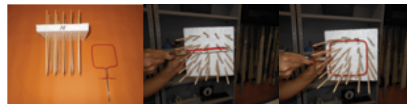
Figura 8: Representação das linhas de campo que saem do ímã e atravessam a área da espira.
