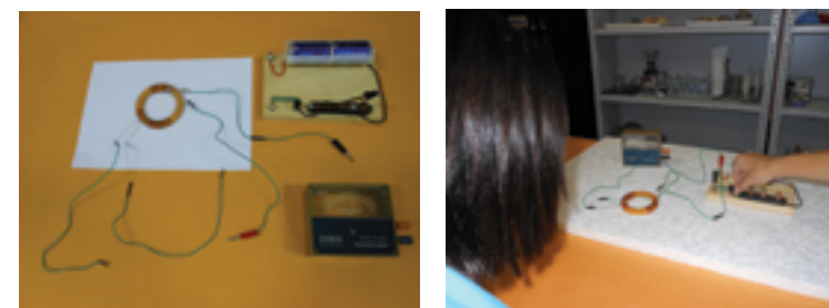
Figura 6: Reprodução do experimento de Faraday. Indução eletromagnética.
