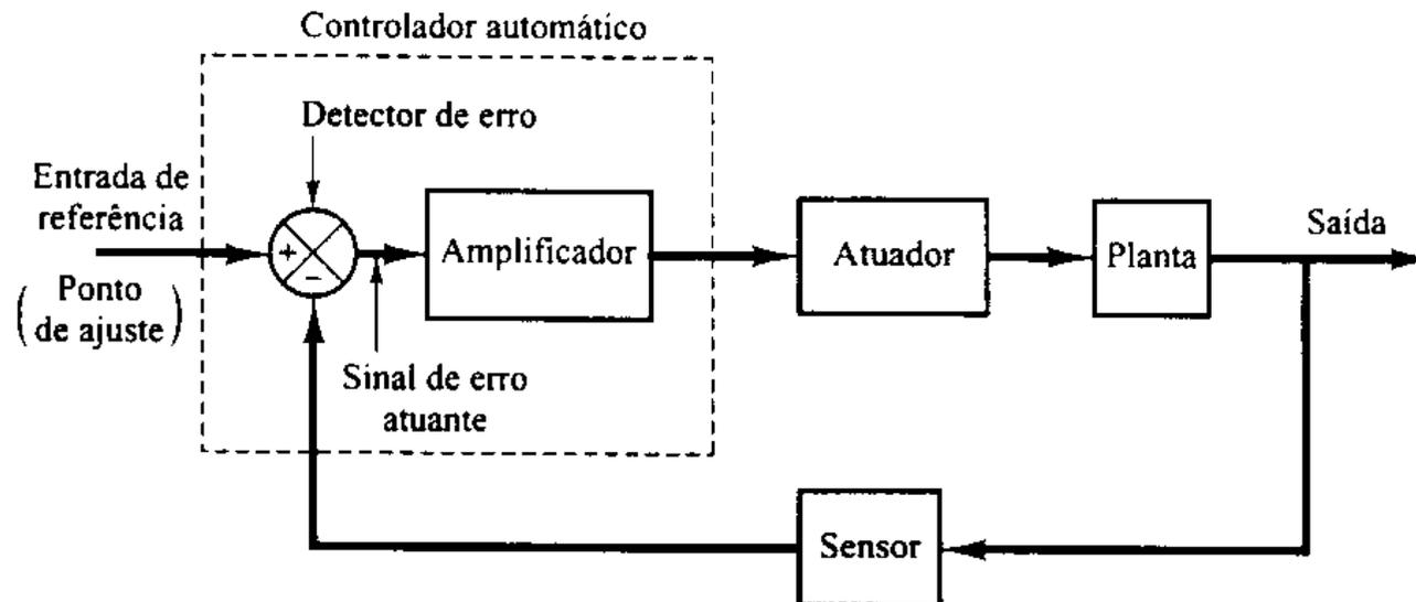
**Figura 3.7** Diagrama de blocos de um sistema de controle industrial, que consiste em um controlador automático, um atuador, uma planta e um sensor (elemento de medição).
