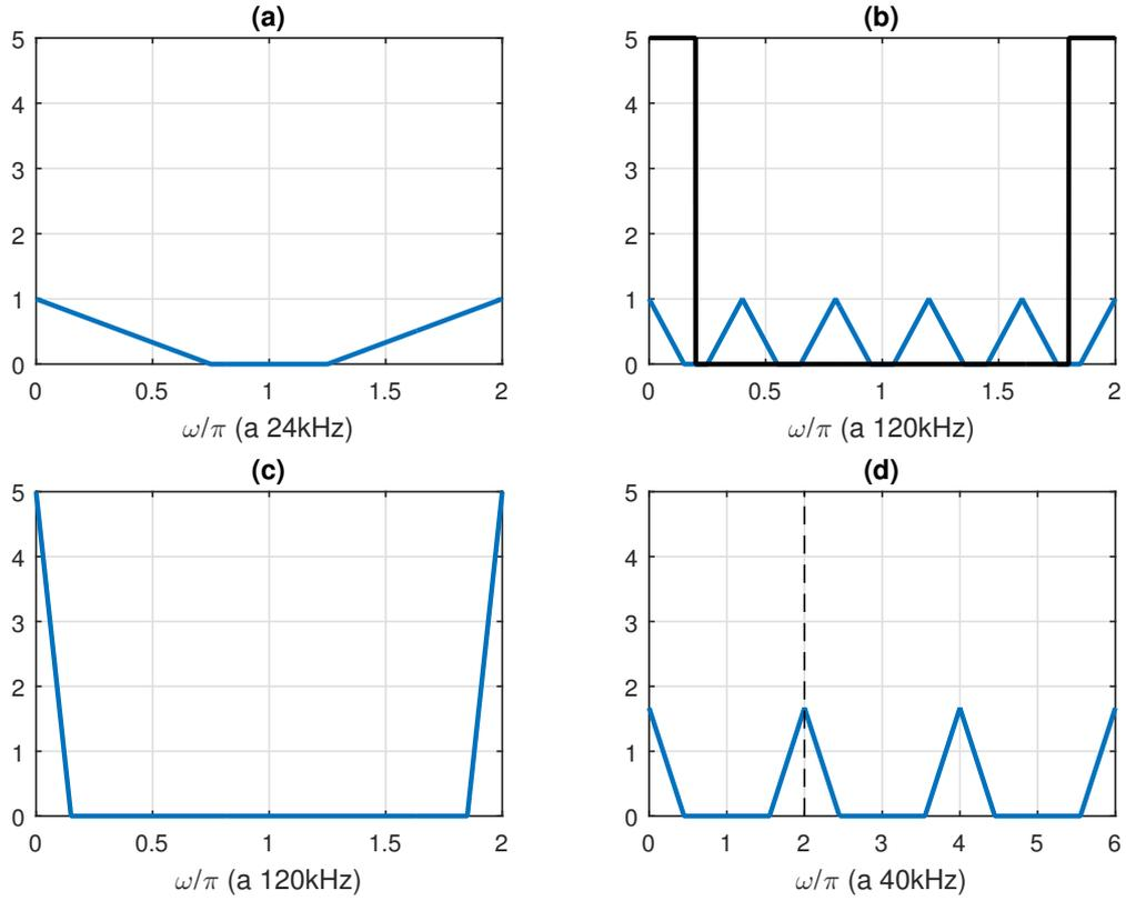
Figura 1: Espectros ilustrativos do sinal em diversas etapas da conversão. (a) espectro do sinal original; (b) espectro do sinal interpolado por zeros, e a resposta em frequência do filtro passa-baixas ideal; (c) espectro do sinal filtrado idealmente; (d) espectro do sinal decimado (atenção à escala da frequência).
