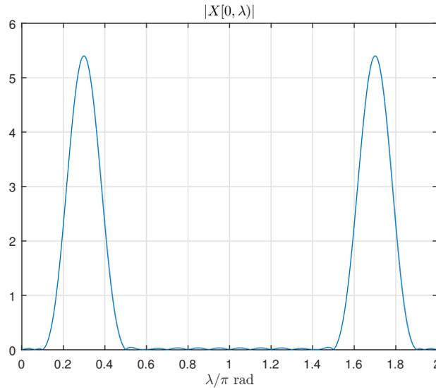
Figura 5:  $|X[0,\lambda]|$  para  $M = 20$ , com janela de Hamming.
