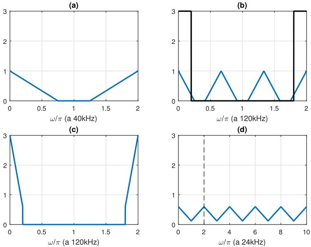
Figura 2: Espectros ilustrativos do sinal em diversas etapas da conversão. (a) espectro do sinal original; (b) espectro do sinal interpolado por zeros, e a resposta em frequência do filtro passa-baixas ideal; (c) espectro do sinal filtrado idealmente; (d) espectro do sinal decimado (atenção à escala da frequência).
