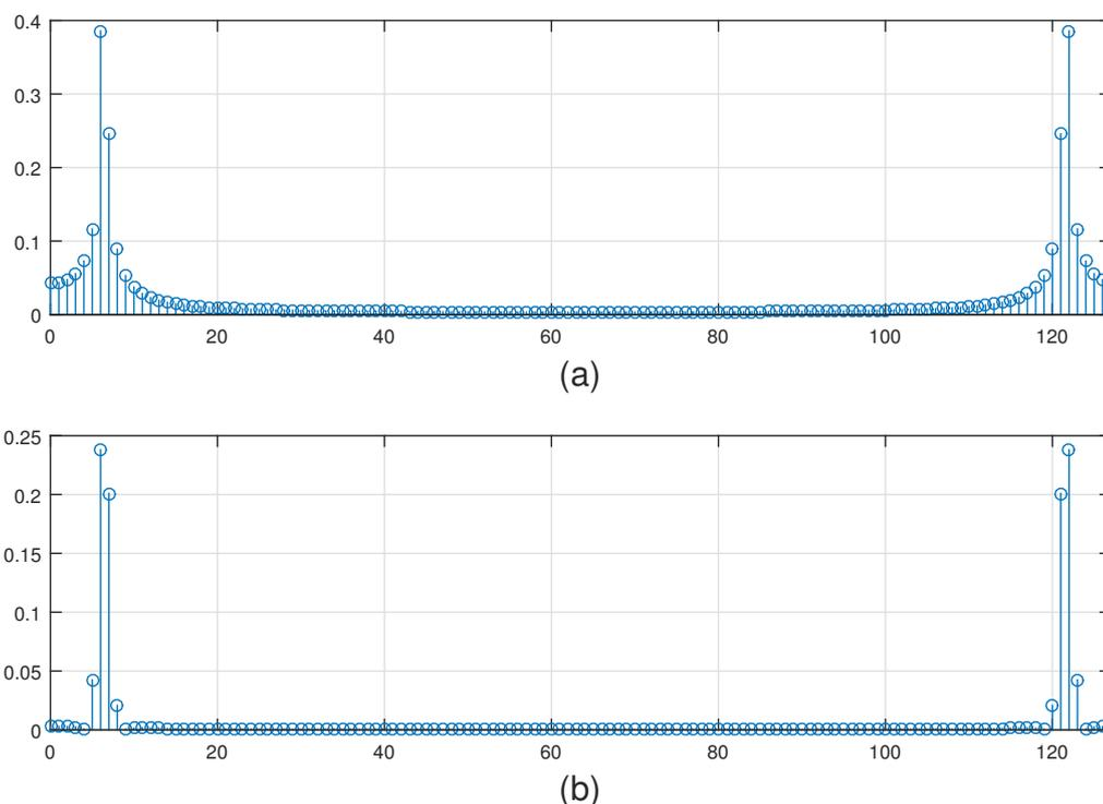
Figura 3: (a) TDF de  $x[n]$  com  $N = 128$  (janela retangular); (b) TDF de  $x[n]$  com janela de Hamming.
