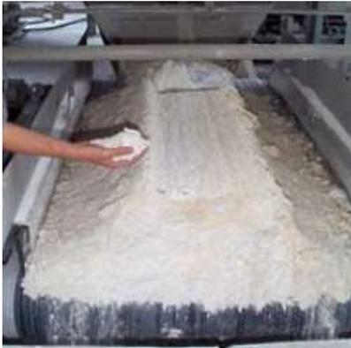
O **GESSO** é o sulfato de cálcio, que tem a finalidade de controlar o tempo de pega (endurecimento) do cimento após a adição de água.
