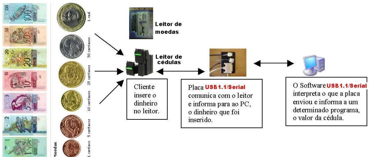
Figura 14 – Componentes do leitor de cédulas e moedas
