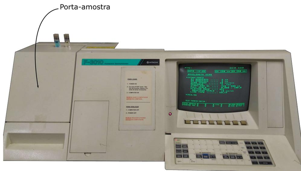
Figura 6.1: Montagem experimental para a espectroscopia de absorção. O porta-amostras está representado juntamente com os botões a serem pressionados no aparelho para a devida coleta de dados.
