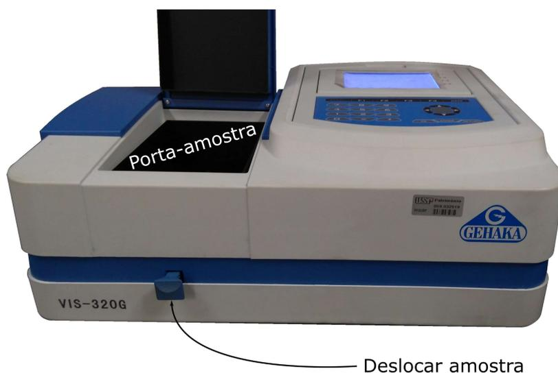
Figura 6.3: Montagem experimental para a espectroscopia de excitação e fluorescência. O porta-amostras está representado juntamente com o local a se realizar o deslocamento interno da amostra.
