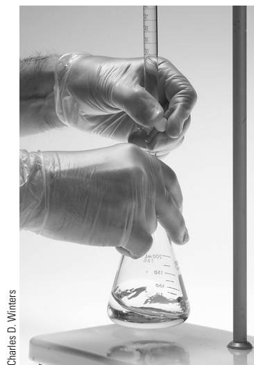
Figura 2-23 Método recomendado para manipulação da torneira de uma bureta.
