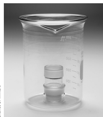
Figura 2-9 Arranjo para a secagem de amostras.
