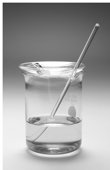
Figura 2-1 Arranjo para a evaporação de um líquido.
