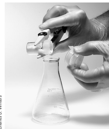
Figura 2-10 Transferência quantitativa de uma amostra sólida. Observe o uso da pinça para segurar o pesa-filtro e de uma tira de papel para segurar a tampa e evitar o contato da pele com o vidro.
