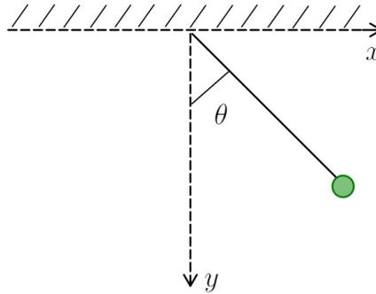
Figura 1: Pêndulo simples de massa  $m$  formado um ângulo  $\theta$  com a vertical. O sistema de coordenadas está embutido na figura.
