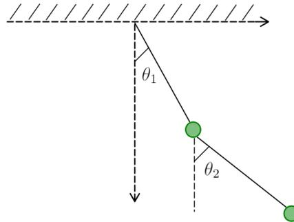
Figura 2: Pêndulo duplo de massas  $m_1 = m_2 = m$  que forma ângulos  $\theta_1$  e  $\theta_2$  com a vertical.
