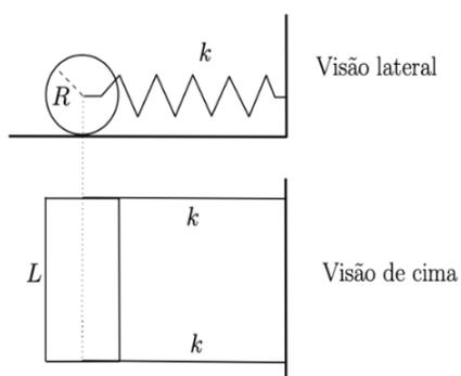
Figure 1: Cilindro conectado a molas.
