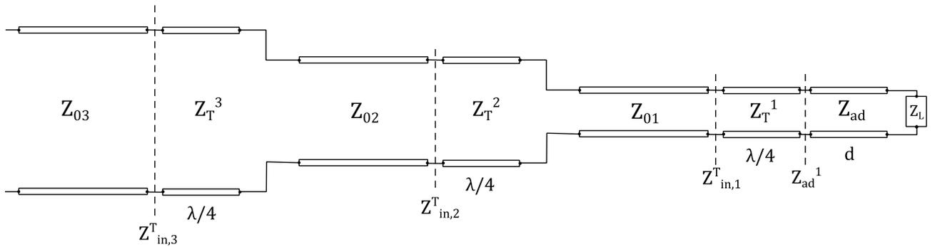
Figura 1: Esquemático de seções de linha e transformadores
