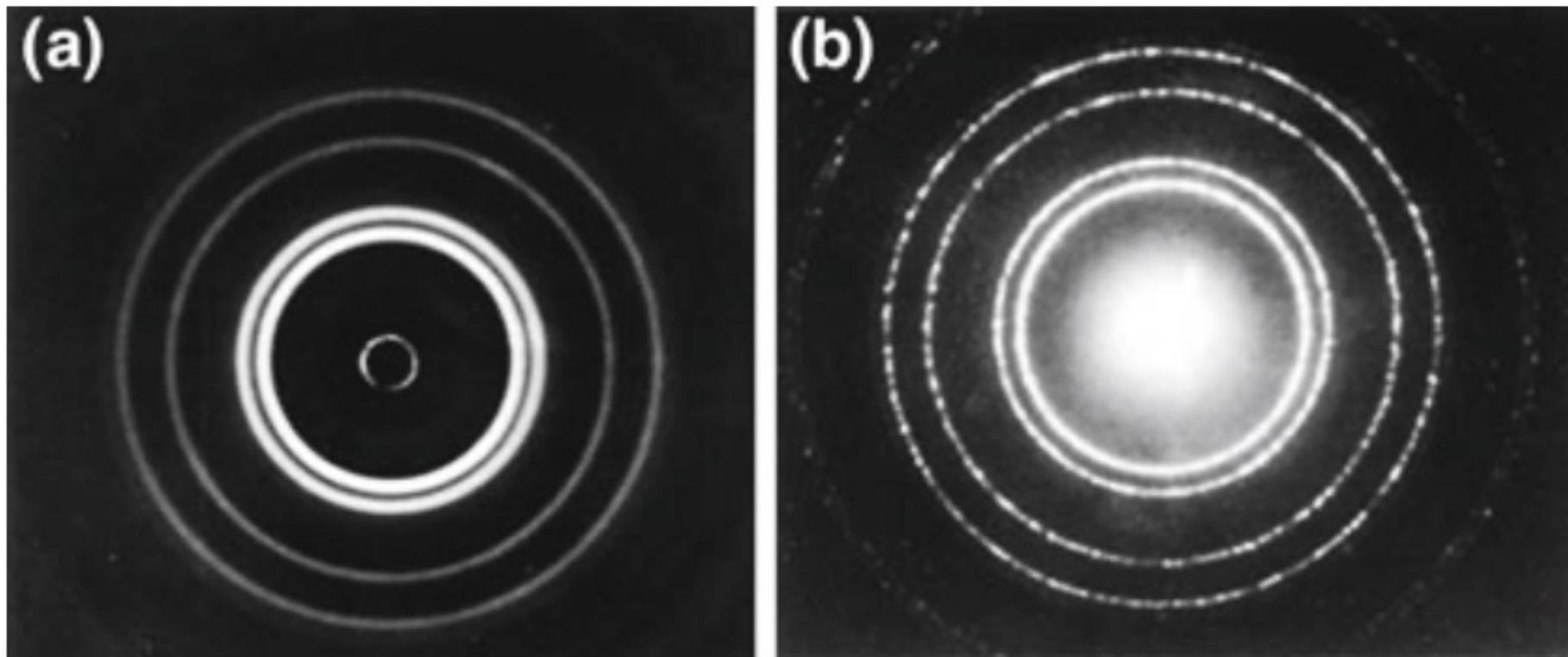
(a) Difração de elétrons e (b) difração de raios-X por lâmina fina de Al cristalino
