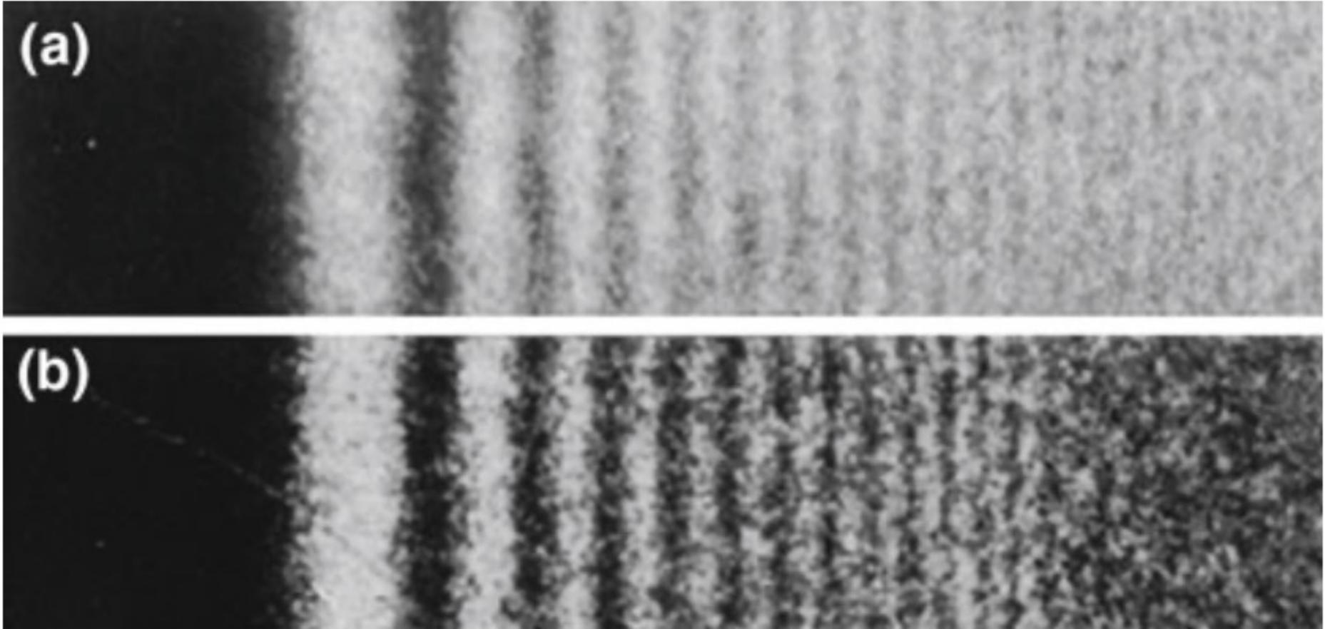
(a) Difração de luz e (b) difração de elétrons com  $T = 38$  keV por monocristal de MgO
