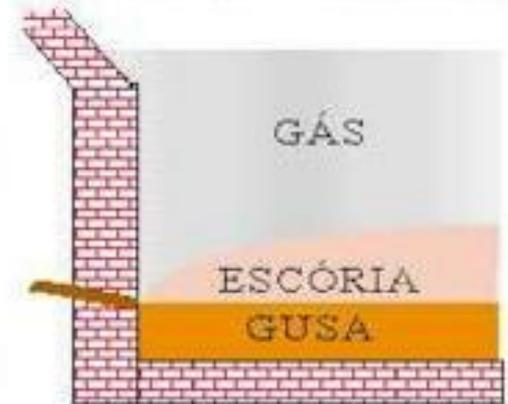
QUANDO A SUPERFÍCIE DA ESCÓRIA ATINGE O FURO O GÁS COMEÇA A SAIR. É O FINAL DA CORRIDA. NESTE INSTANTE, DEVIDO À INCLINAÇÃO DA SUPERFÍCIE, PARTE AINDA FICA DENTRO DO FORNO
