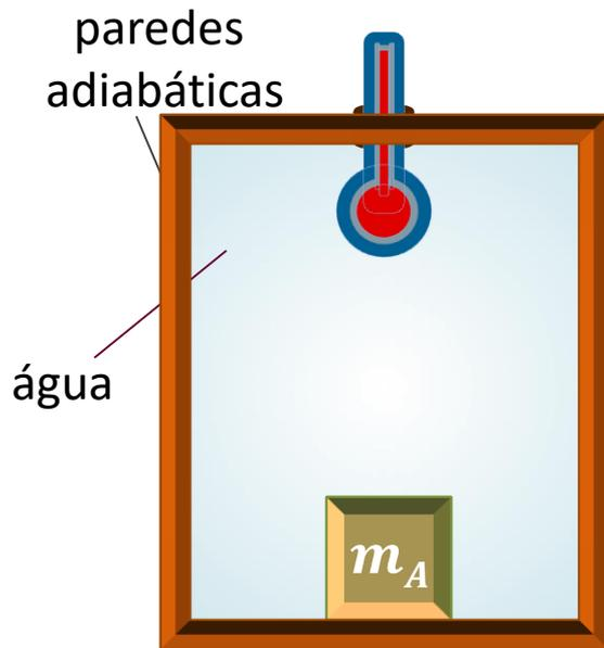
Após o equilíbrio térmico ter sido atingido, a temperatura do sistema é  $T_f$  (medida pelo termômetro). A **quantidade de calor perdida pela amostra  $A$  é inteiramente cedida à água**
