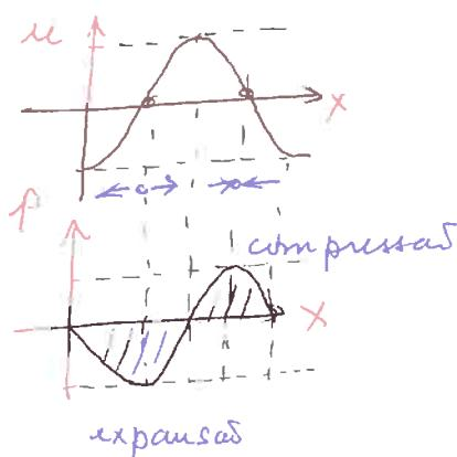
$$\text{Potência: } F_o = \frac{F \partial u}{\partial t} = w A P M \sin^2(kx - \omega t + \delta)$$
