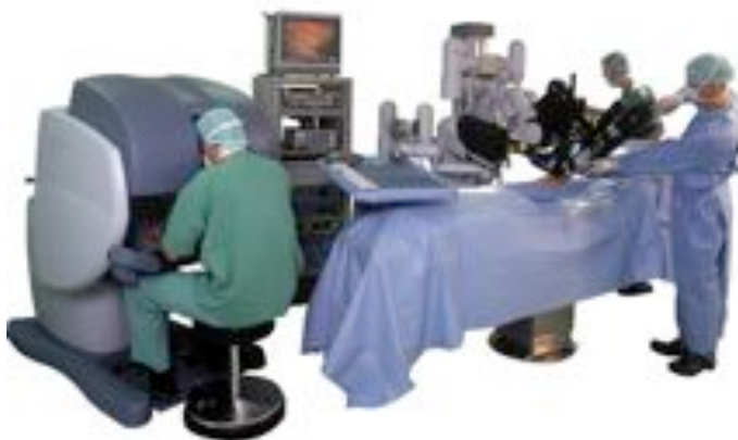
Figura 5.6: Primera generación del sistema DaVinci (1999). Extraído de Intuitive Surgical
