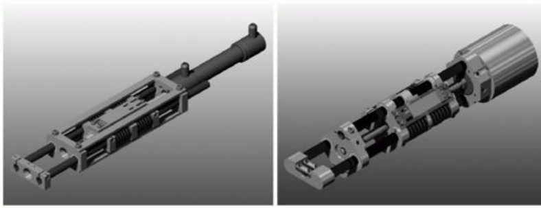
Figura 1.10: Ejemplos CAD de Series Elastic Actuator con actuadores hidráulicos y eléctrico. Extraído de [34]
