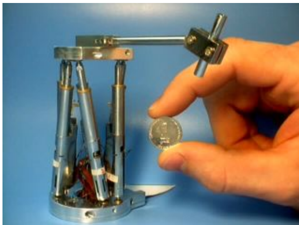
Figura 1.5: SpineAssist - Robot paralelo para operar en la colocación de fijaciones mecánicas de prótesis en la columna vertebral. Cortesía de Mazor Inc.
