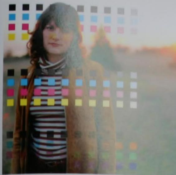
Imagen en color en la que se han sobreimpreso una serie de colores degradados (que oscilan entre 100 % y 10 %). El conjunto de colores del medio se ha calado, con lo cual se mantienen los colores. Los que se sobreimprimen, sobre todo los más claros, dejan ver más imagen. Como puede verse en la parte superior, las áreas sin demasiado color producen una escasa interferencia con la franja de colores, mientras que en la parte inferior la interferencia es elevada.
