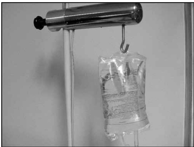
Figura 3. Balança invertida. O peso que diminui na bolsa de soro é registrado positivamente no gráfico na unidade de tempo.
