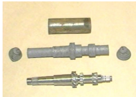
Figura 2.13 – (a) eixos obtidos por CWR e recalque, (b) seqüência de fabricação do eixo.
