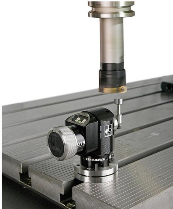
Figura 3.15 – Exemplo de medição automática da ferramenta em um centro de usinagem.
