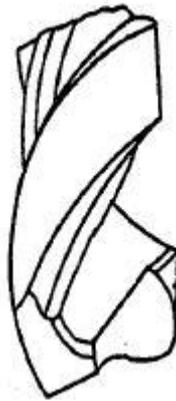
Figura 2.12 – Exemplo de uma broca com canais helicoidais especiais que atuam como quebra cavacos.
