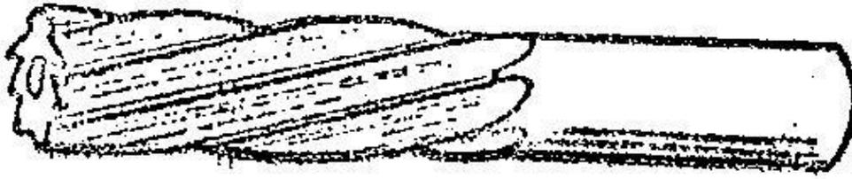
Figura 2.3 – Fresa com cabo cilíndrico, hélice à esquerda.
