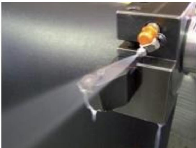
Figura 2.17 – Exemplo de um sistema MQF- mínima quantidade de fluido para torneamento.
