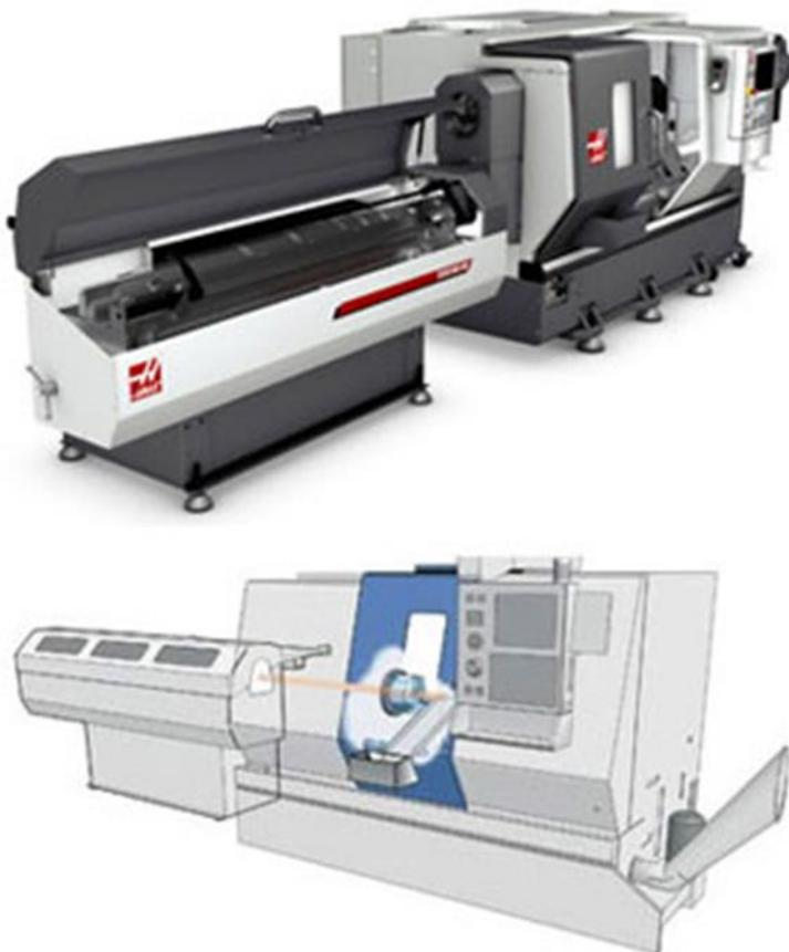
Figura 2.8 – Alimentador de barras acoplado a um torno CNC
