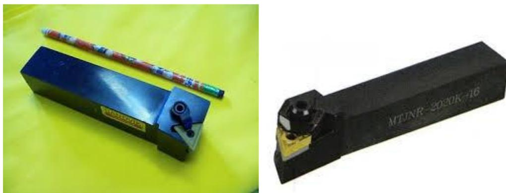
Figura 2.12 – Porta-ferramentas para inserto triangular com diferentes disposições.
