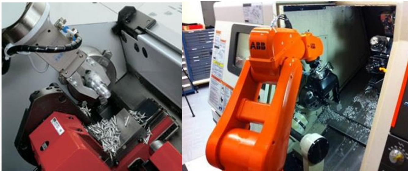
Figura 2.9 – Sistemas de alimentação de peças usando braço robótico
