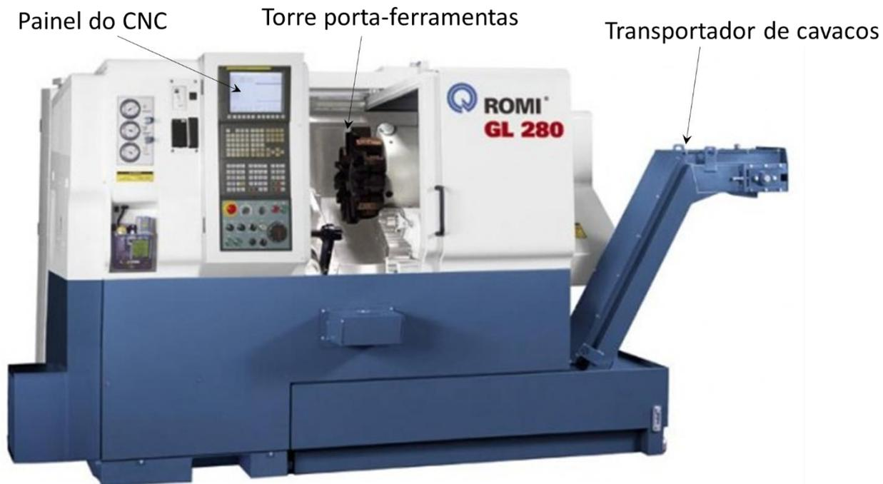
Figura 1 – Exemplo de um torno CNC com algumas partes fundamentais. Cortesia de Indústrias ROMI S.A..
