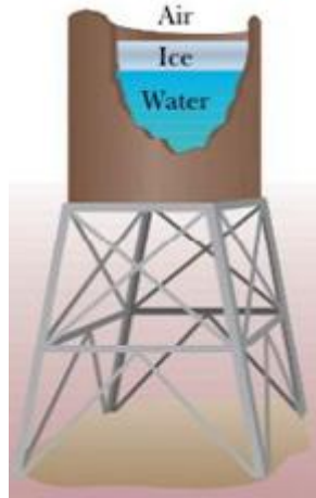
Figura 6: Caixa d'água com camada de gelo
