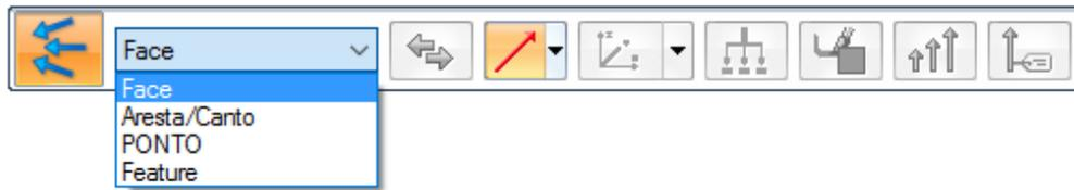
8. Colocaremos uma força de 100kN em cada extremidade do parafuso que segura a polia, totalizando uma força de 200kN aplicada sobre a estrutura. Selecione uma das faces do parafuso.
