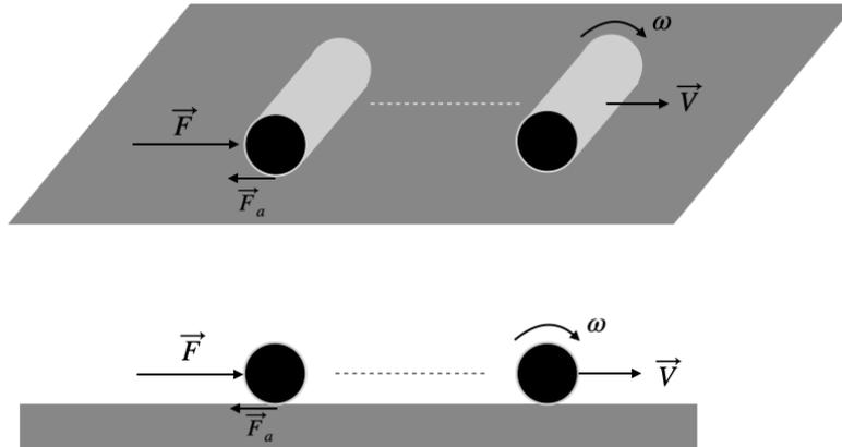
Figura 3: Um cilindro de massa  $M$  e raio  $R$ , inicialmente em repouso, sofre uma força externa  $\vec{F}$  aplicada na altura do centro de massa. No ponto de contato do cilindro com o plano há uma força de atrito  $\vec{F}_a$ .
