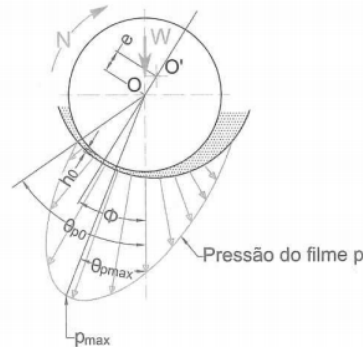
Figura com a distribuição de pressão do filme mostrando a notação utilizada. \phi - posição angular da espessura mínima do filme de óleo; p_{max} - pressão máxima desenvolvida no filme; \theta_{p_{max}} - posição angular da pressão máxima; \theta_{p_0} - posição angular da pressão nula sobre o filme de óleo. Adaptado a partir de Hamrock, Schmid e Jacobson, 2005.
