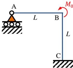
A estrutura  $ABC$  da figura está contida em um plano vertical e é formada pelas barras  $AB$  e  $BC$ , ambas de comprimento  $L$ , rigidez flexional  $EI$  e peso próprio desprezível. Pede-se:
