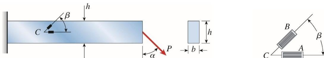
7.7-22. As deformações na superfície de um dispositivo experimental feito em alumínio ( $E = 70 \text{ GPa}$ ,  $\nu = 0,33$ ) e testado em um ônibus espacial foram medidas por meio de extensômetros orientados conforme a figura. As deformações medidas foram  $\varepsilon_a = 1100 \times 10^{-6}$ ,  $\varepsilon_b = 1496 \times 10^{-6}$  e  $\varepsilon_c = -39,44 \times 10^{-6}$ . Qual o valor da tensão  $\sigma_x$ ? Resp.:  $\sigma_x = 91,6 \text{ MPa}$ .
