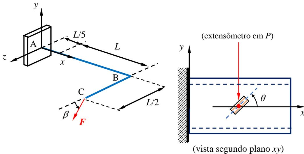
4) Para se determinar o estado de tensão em um dado ponto de um elemento de máquina foi utilizada uma roseta a 60°, conforme ilustra a figura a seguir. Após a aplicação do carregamento, as leituras obtidas pelos extensômetros *a*, *b* e *c* foram, respectivamente:
