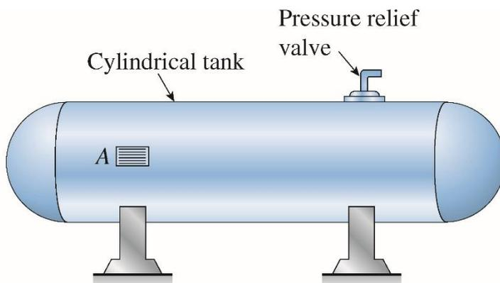
8.3-12. Um tanque de aço pressurizado é feito com uma solda helicoidal que forma um ângulo  $\alpha = 55^\circ$  com o eixo longitudinal (vide figura). O tanque tem raio de 600 mm e espessura de 18 mm. A pressão interna aplicada é de 2,8 MPa e o material possui constantes elásticas:  $E = 200$  GPa e  $\nu = 0,30$ . Determine as quantidades a seguir para a parte cilíndrica do tanque (longe das extremidades):
