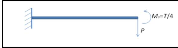
Considerando a simetria da estrutura, na aplicação do momento de torção, o seu nó central deve permanecer na mesma posição. Assim, cada barra horizontal pode ser representada pela barra equivalente:
