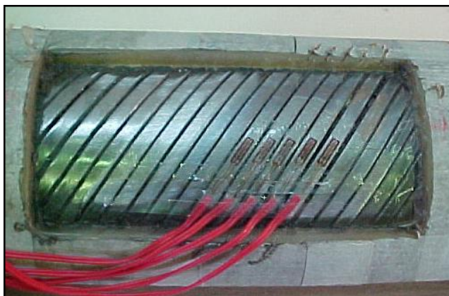
Figura 14 – Exemplo de aplicação de extensômetros.
