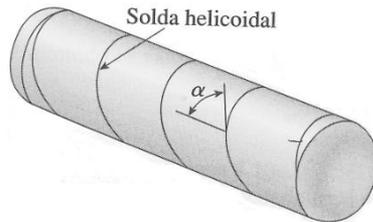
Um vaso de pressão cilíndrico é construído a partir de uma placa de aço longa e fina, enrolando-se a placa de aço em torno de um mandril e então se soldando ao longo das bordas da placa para fazer uma junção helicoidal, conforme a figura. A solda helicoidal faz um ângulo  $\alpha = 45^\circ$  com o eixo longitudinal. O vaso tem raio interno  $r = 1,8 \text{ m}$  e espessura da parede  $t = 20 \text{ mm}$ . A pressão interna  $p$  é  $800 \text{ kPa}$ . Pede-se calcular:
