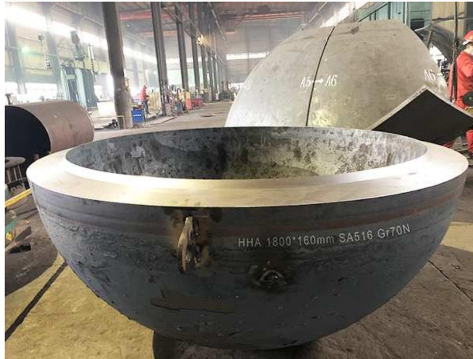
Fig.3: Tampo hemisférico de parede espessa [3].
