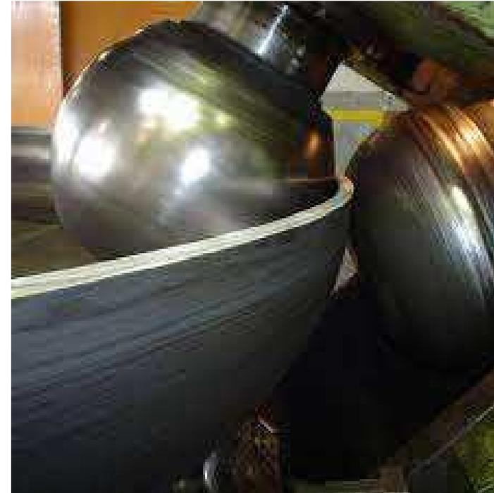
Fig.2: Fabricação de tampos
