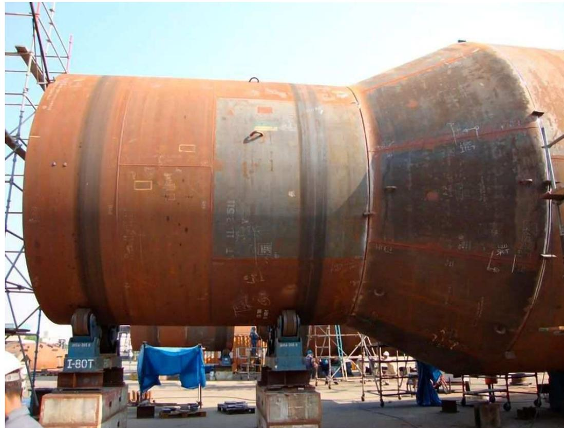
Fig.8: Detalhe de uma seção cônica (tronco de cone) unindo duas seções cilíndricas de um vaso de pressão.
