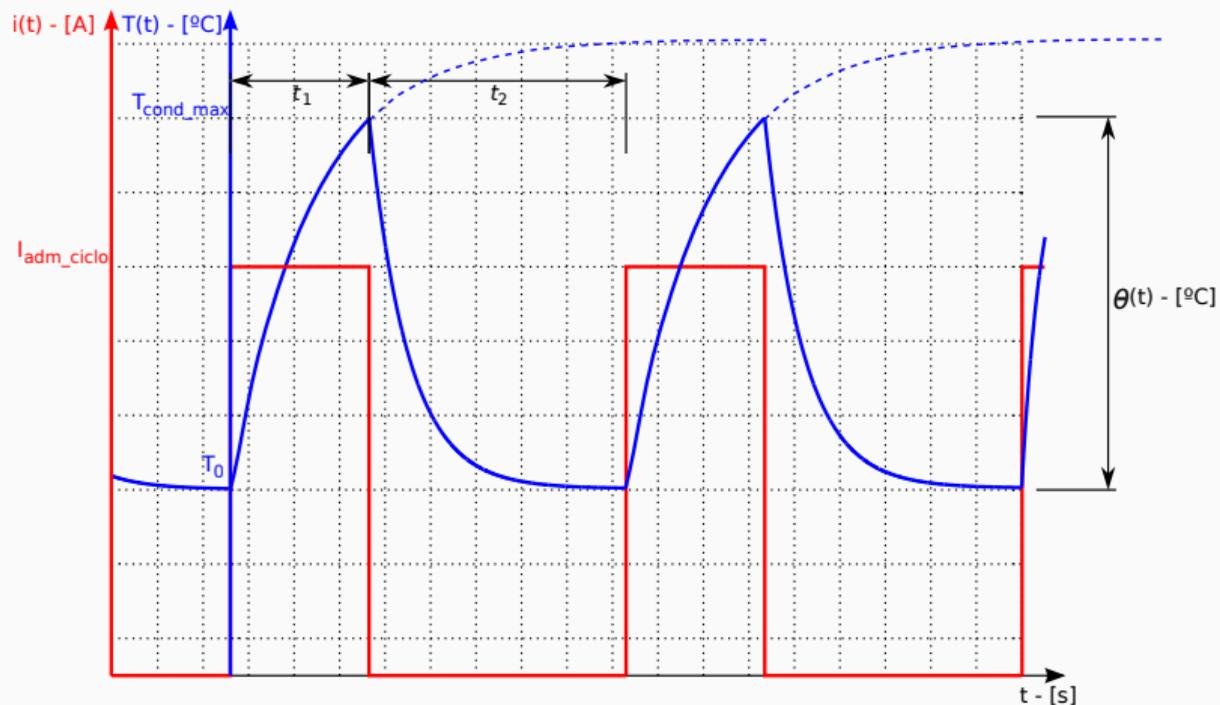
$t_1$  : intervalo de aquecimento ( $I \neq 0$ ) e  $t_2$  : intervalo de resfriamento ( $I = 0$ )
