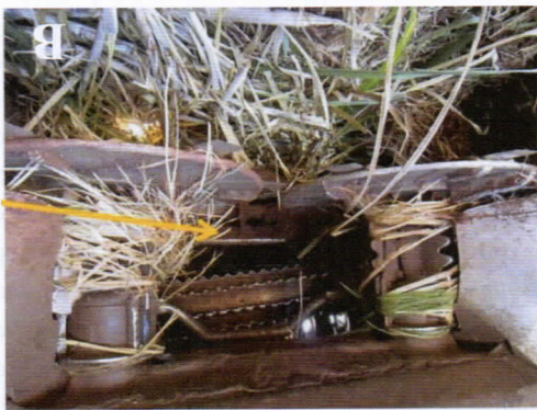
Figura 9. Modelos de corte de base fixo da Colhedora John Deere 3522 (A); Detalhe do corte de base mais largo com discos de corte fixos (B).
