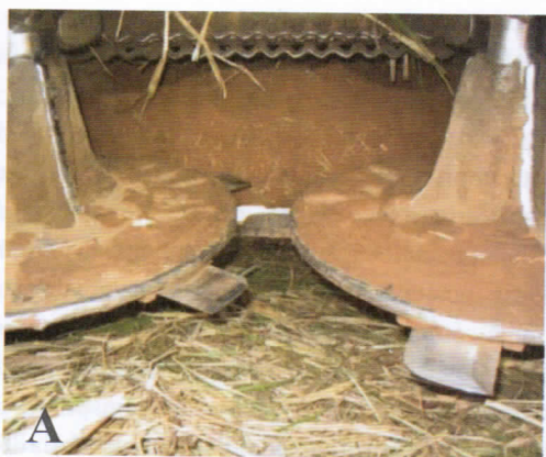
Figura 5. Colhedora contaminada com impureza mineral aderida ao rolo alimentador e ao disco de corte basal (A) e ao capuz do extrator secundário (B).
