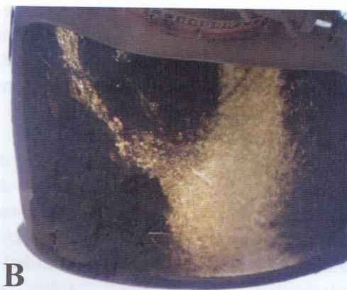
Figura 5. Colhedora contaminada com impureza mineral aderida ao rolo alimentador e ao disco de corte basal (A) e ao capuz do extrator secundário (B).
