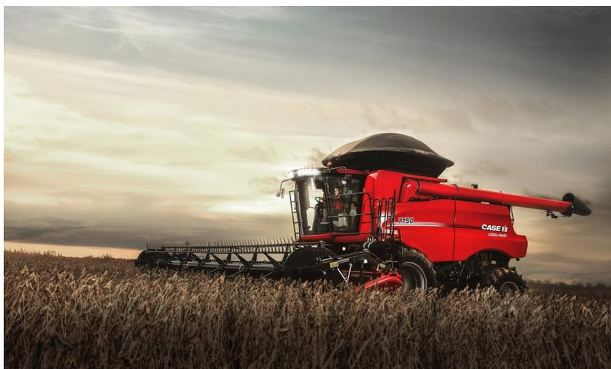
A Case IH Axial-Flow 7150 tem sistema de trilha com rotor com diâmetro de 0,762m, área de trilha de 1,1m<sup>2</sup> e 1,7m<sup>2</sup> de separação
