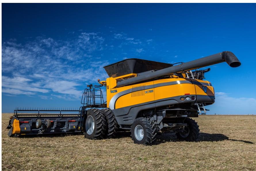
A Valtra BC 7800 tem rotor com diâmetro de 0,80m com 1,36m<sup>2</sup>de área de trilha e 2,2m<sup>2</sup>para separação
