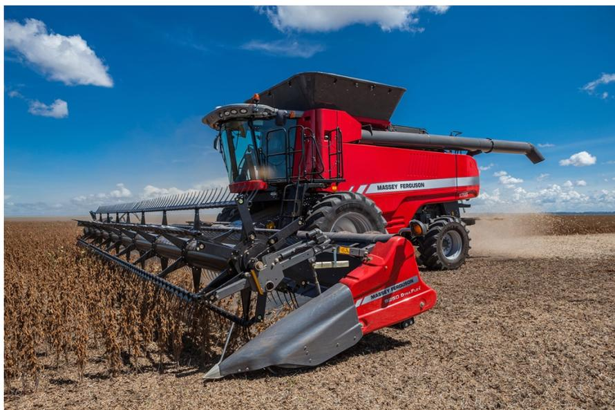
A MF 9795 vem equipada com rotor com diâmetro de 0,80m com 1,36m<sup>2</sup> de área de trilha e 2,2m<sup>2</sup> para separação
