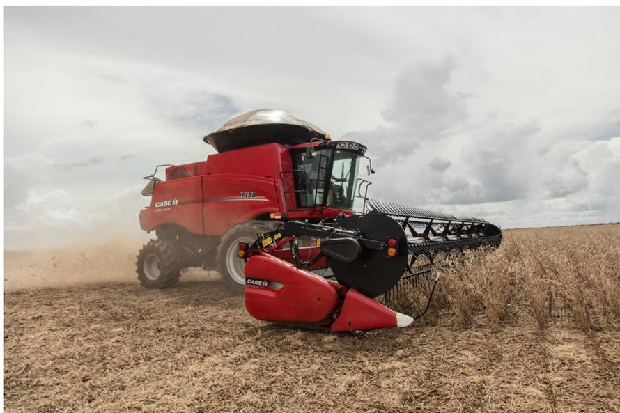
Case IH Axial-Flow 7150 vem com motor FPT, modelo FPT Cursor 9, com 378cv de potência
