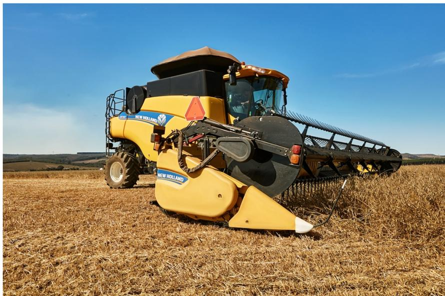
New Holland CR Evo 7.80 vem equipada com motor FPT, modelo FPT Cursor 9, com 378cv de potência
