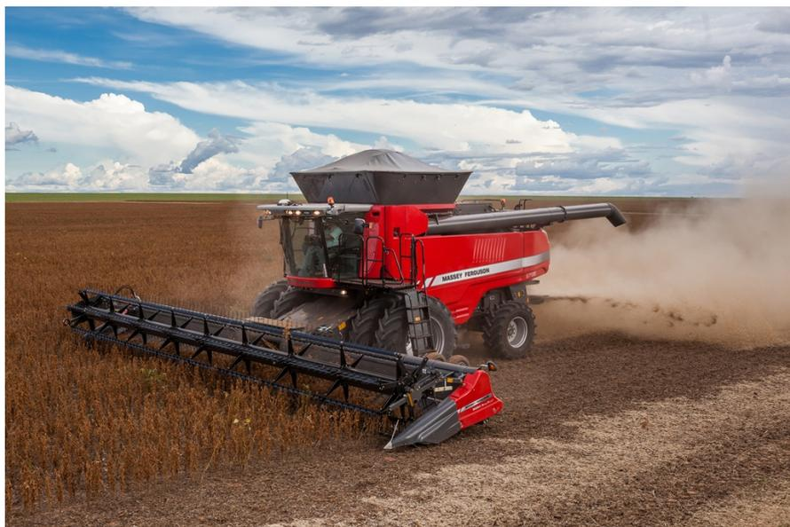
MF 9795 vem equipada com motor AGCO Power, modelo 9.8AT3, de 415cv de potência
