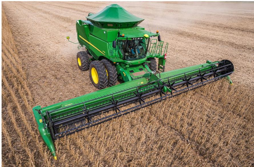
A John Deere S770 possui rotor com diâmetro de 0,762m com 1,1m<sup>2</sup> de trilha e 1,54m<sup>2</sup> de separação
