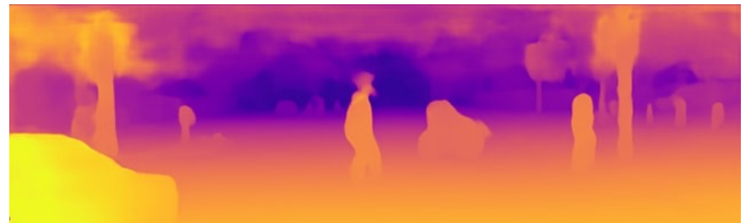
Resultado de estimativa de profundidade. Cores quentes indicam objetos mais próximos da câmera.
