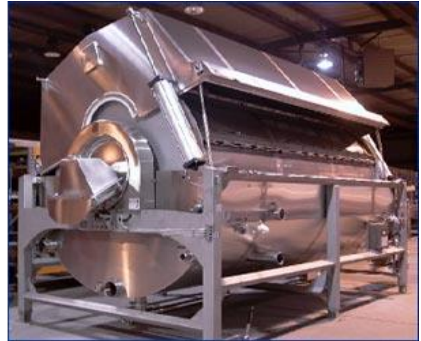
Branqueador contínuo por água - tipo tambor rotatório
