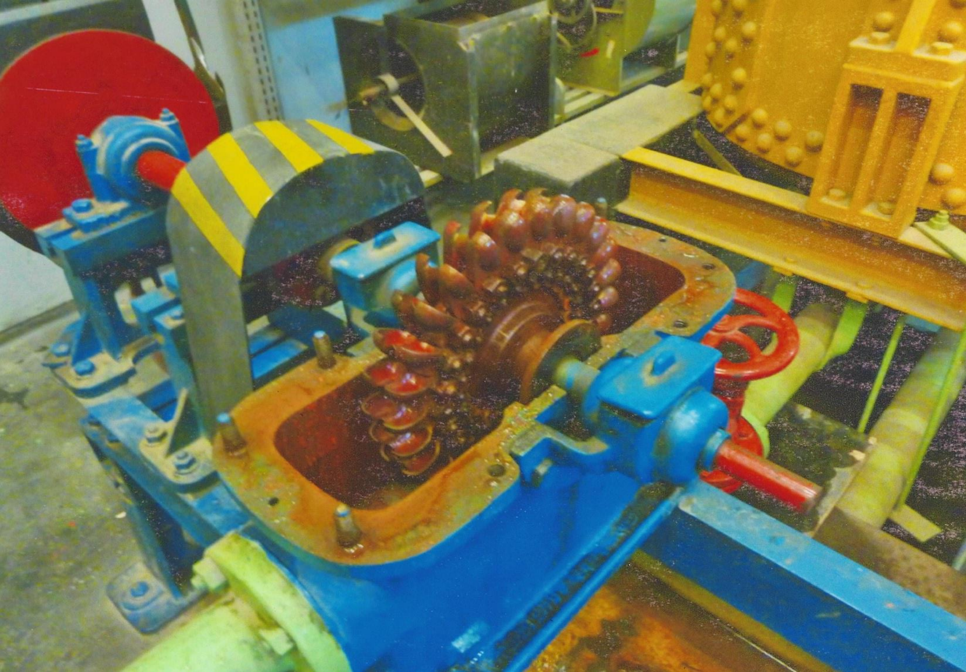
Figura 3.3. Detalhe do Rotor da Turbina Pelton. D = 316 \text{ mm} (Atuação do jato)
