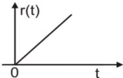
Degrau  $\begin{cases} u(t) = At \text{ se } t \geq 0 \\ u(t) = 0 \text{ se } t < 0 \end{cases}$
