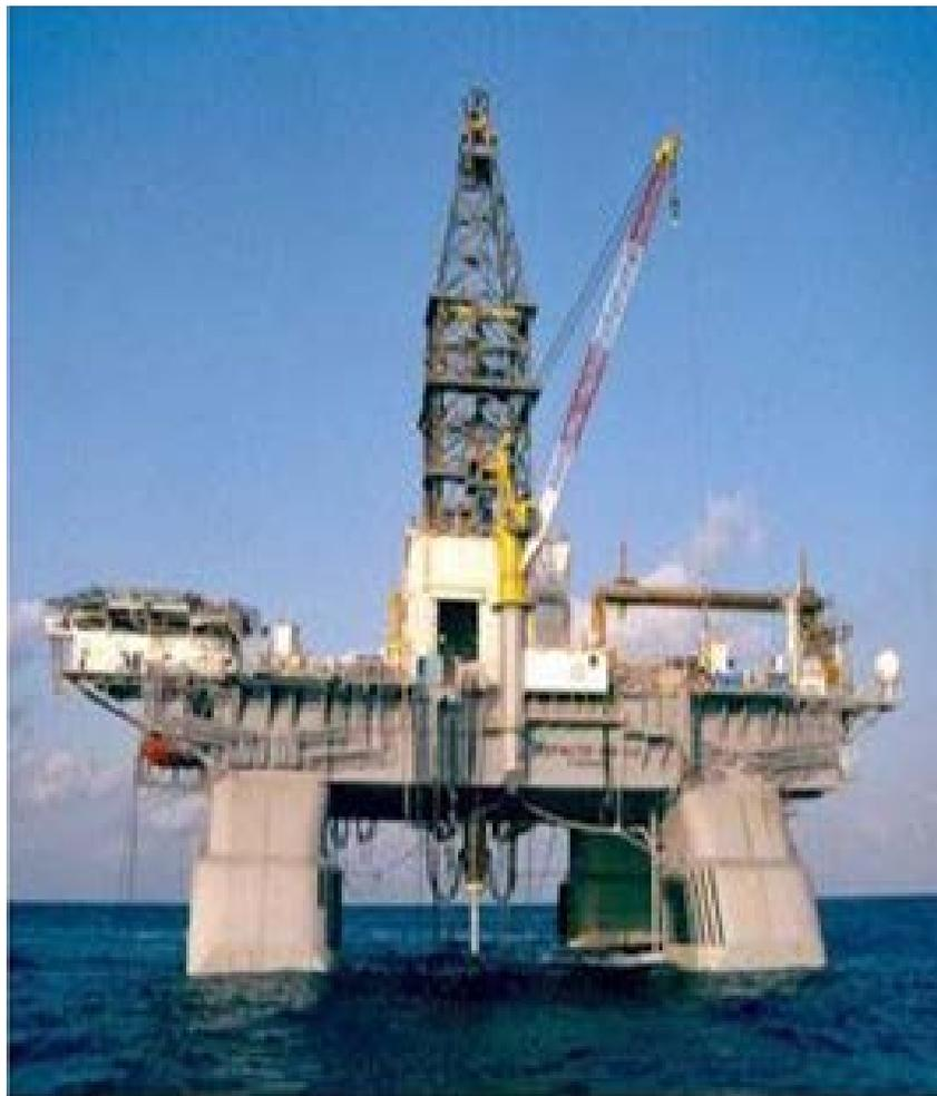
*Deepwater Horizon* era uma torre petrolífera de desenho RBS-8D de quinta geração, semi-submersível, com posicionamento dinâmico e projetada para águas ultra-profundas
