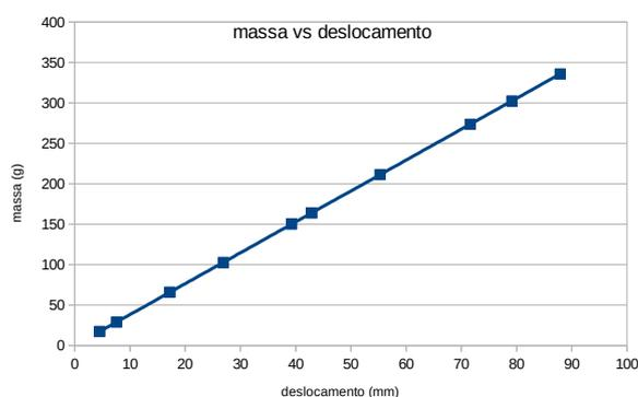
Fig. 1 - esboço de como deve parecer o gráfico de m vs  $\Delta x$ , e a reta ajustada manualmente.
