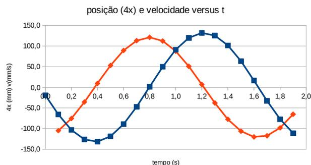
Figura 2 – posição (azul) e velocidade (vermelho) do sistema massa-mola.
