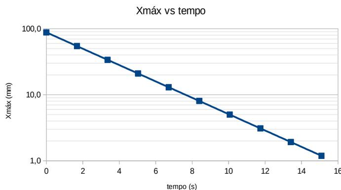
Figura 4 – Massa-mola com atrito viscoso: amplitude máxima versus tempo em escala monolog.
