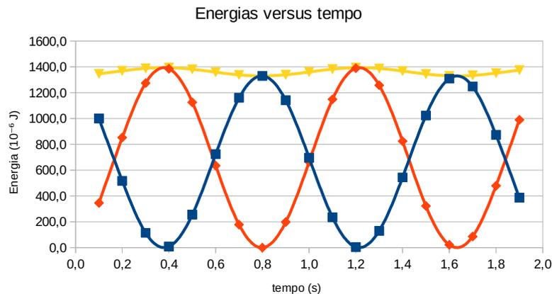
Figura 3 – Sistema massa-mola sem atrito – Energias versus tempo.  $E_p$  em vermelho,  $E_c$  em azul e  $E_m = (E_p + E_c)$  em amarelo.
